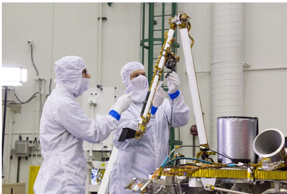
NASA/JPL-Caltech/Lockheed Martin Space (sin fecha). Pruebas previas al lanzamiento del brazo robótico de InSight. NASA https://www.jpl.nasa.gov/spaceimages/details.php?id=PIA22741
